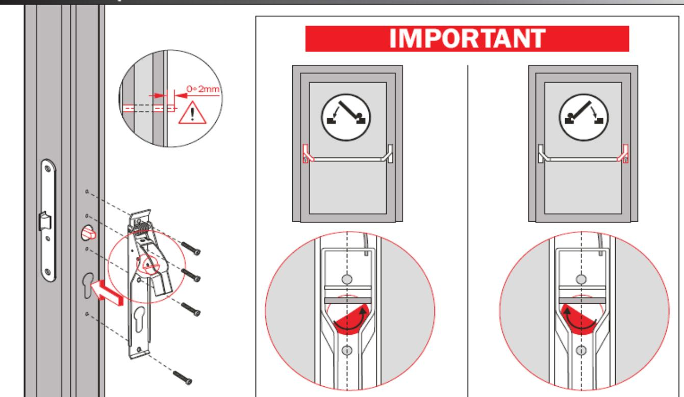
**9** Fissaggio lato cerniere - Hinge side fixing
