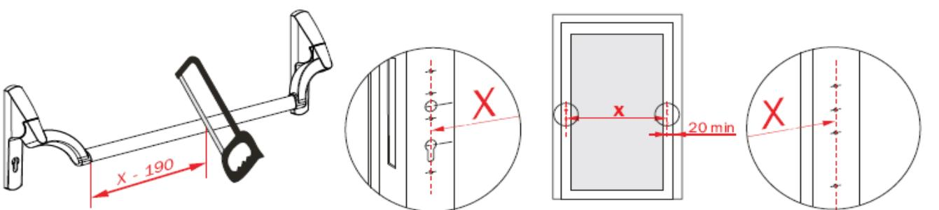
**8** Fissaggio lato serratura - Lock side fixing
