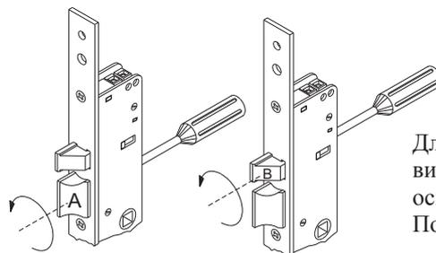
Для поворота основной защелки ослабьте винт защелки "А" настолько, чтобы освободить ее, поверните и закрутите винт. Повторите для защелки "В".
