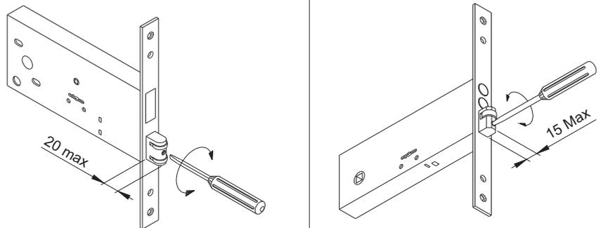
Регулировка вылета ролика
