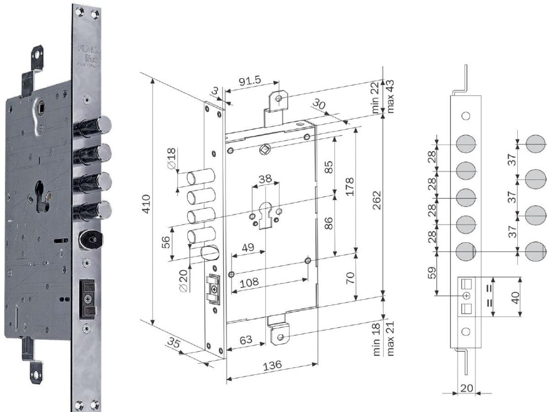
Моторный замок ISEO x1R Easy является основным вариантом надёжного и мощного исполнительного устройства, управляемого аксессуарами контроля доступа любых производителей.
